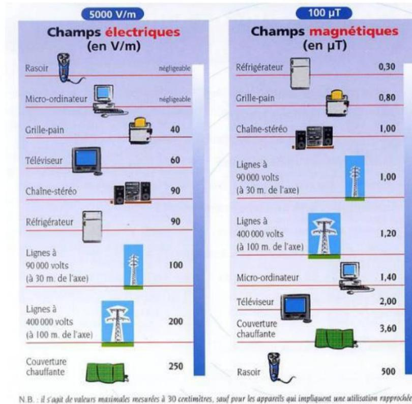
Figure 1 : Comparaison entre champ électrique (V/m) et champ magnétique (µT)<sup>16</sup>
